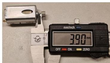
Da die Motorwelle etwas kürzer ist, empfehlen wir das Slot.it Motorritzel 12Z für Ø2mm M50 Ergal, Art. Nr.: PI7012e. Der Abstand vom Motorritzel zum Motor, +/- 4.0mm
