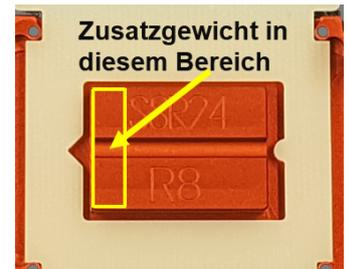
**Zusatzgewicht nur bis max.165.5gr. für komplettes Fahrwerk. Schwere Fahrwerke dürfen kein zusätzliches Gewicht mitführen.**
